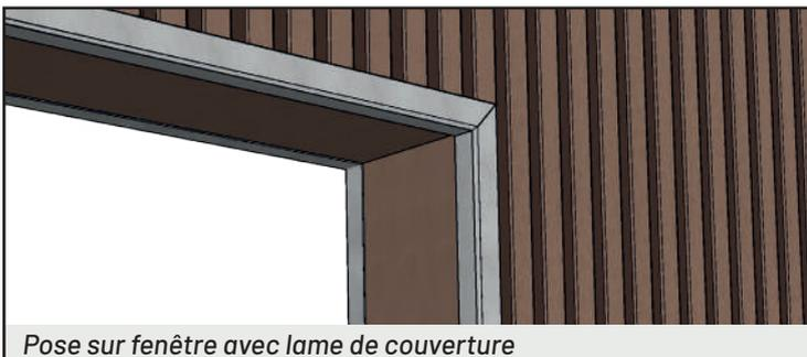
Pose sur fenêtre avec lame de couverture
